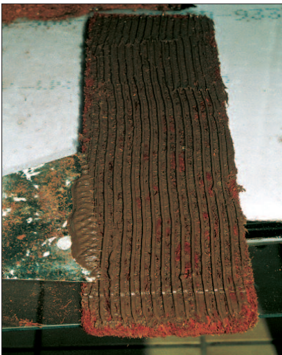
Danach wird die Platte mit einem Zahnpachtel bearbeitet, wodurch man sie leichter an der Glasscheibe positionieren kann.
